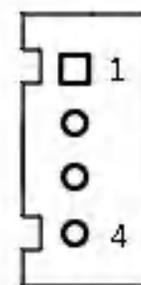
⚠注意: SATA\_PWR 硬盘供电接口的第 1 脚为 12V 输出, 第 4 脚为 5V 输出, 使用时须用我司所标配的电源线, 以免烧坏硬盘。
