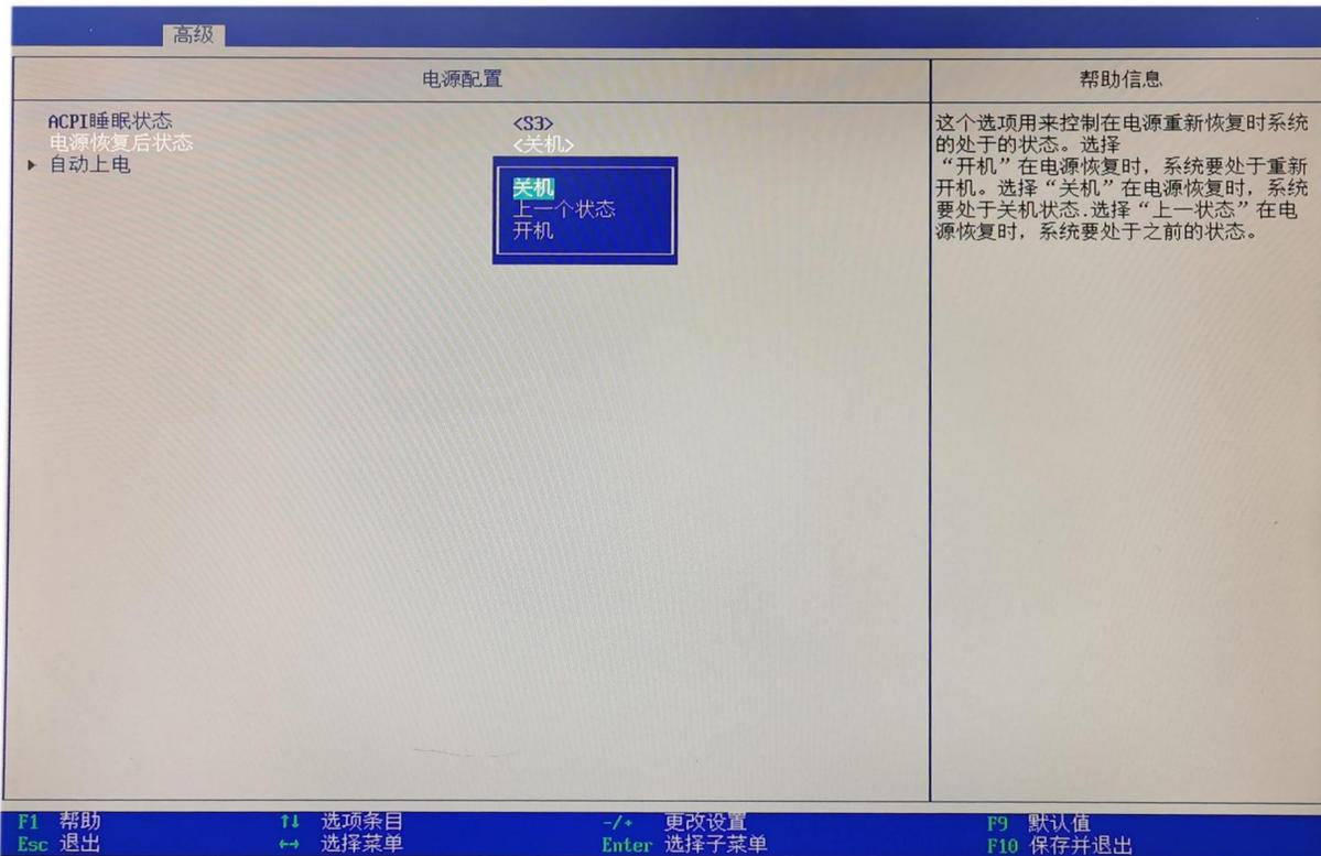
默认上电开机关闭，设置成“开机”为上电开机开启
