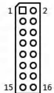
⚠注意：插 HDMI 线时，线第一针脚务必对应主板插针第一针脚，插反了或者插错位了会无显示。
